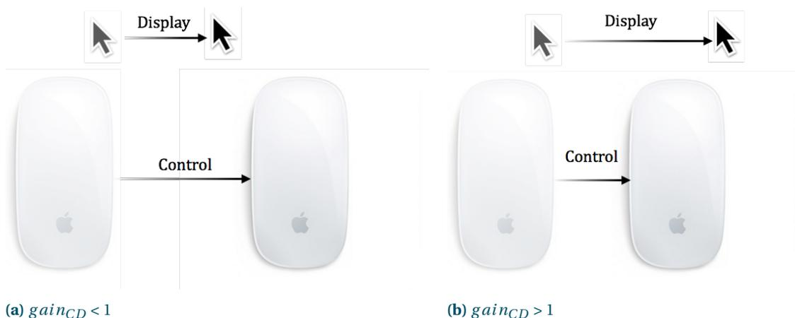
**FIGURE 5.1** – À gauche, le  $gain_{CD}$  est inférieur à 1. Tout mouvement dans l'espace moteur produit un mouvement d'amplitude plus faible en sortie (ici le mouvement du curseur). L'utilisateur perd en amplitude, mais gagne en précision. À droite, le  $gain_{CD}$  est supérieur à 1. Tout mouvement dans l'espace moteur est donc, à l'inverse, plus grand en sortie. L'utilisateur gagne en amplitude, mais perd en précision.
