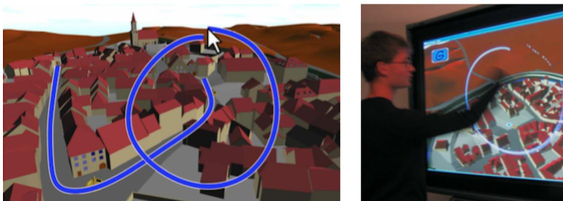
**FIGURE 3.13** – Un utilisateur dessine le chemin que la caméra devra suivre dans la scène 3D. Le dessin d'un cercle à la fin du tracé signifie que la caméra doit réaliser une rotation complète sur elle-même afin d'obtenir un aperçu de la scène (*overview*) lorsque celle-ci arrive au bout de son chemin.
