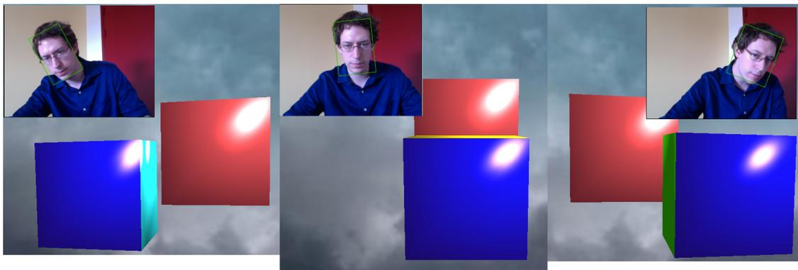
**FIGURE 3.19** – La perspective couplée à la tête renforce la perception de l'utilisateur en adaptant le rendu de la scène 3D par rapport à la position de la tête de l'utilisateur. Ainsi, si celui-ci se penche à gauche (image de droite), la scène est translaturée sur la gauche et la caméra s'oriente verticalement pour conserver le point central de la scène au centre de son champ de vision.
